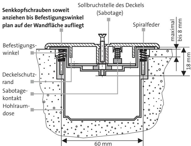
diese Weise ausgeglichen werden. Sollte die Wandfläche im Bereich des Deckels Unebenheiten aufweisen (z. B. Rauhputz), sind diese einzuebnen.
