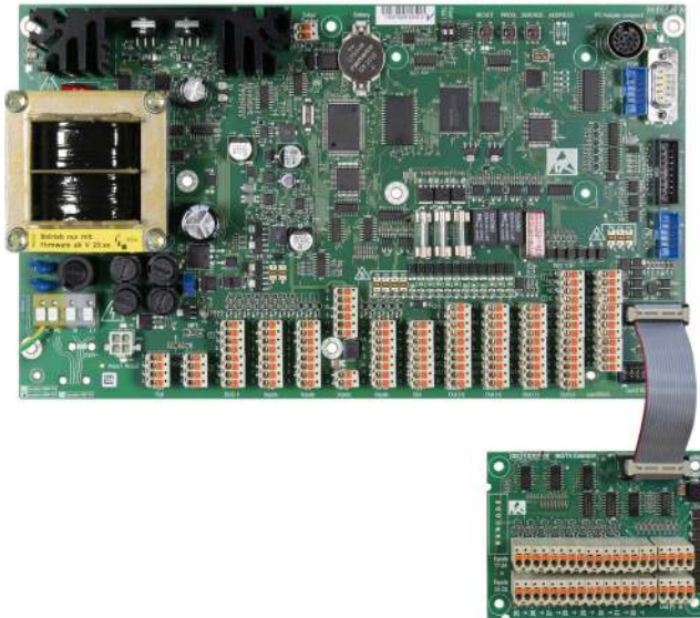
Anbindung Erweiterungsplatine MG/TA-FK an Einbruchmelderzentrale complex 400H-FK
