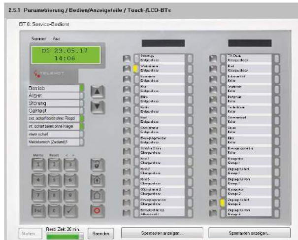
Ferndiagnose: Service-Bedienteil-Simulation mit Parametriersoftware compasX
