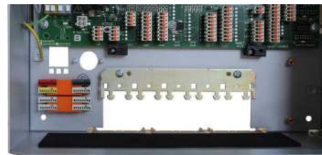
Befestigungsadapter mit MICRO-Verbindungsklemmen im Gehäusety p GR80
