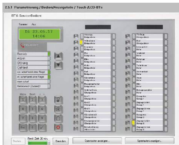
Ferndiagnose: Service-Bedienteil-Simulation mit Parametriersoftware compasX
