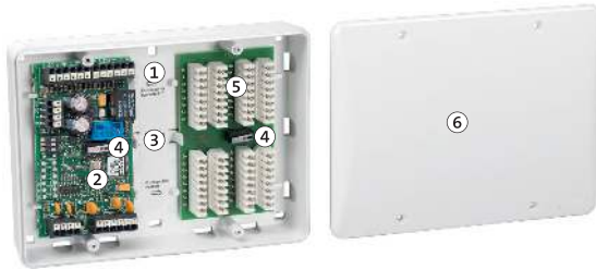
Mechanischer Aufbau 5-MGM C2B mit LSA-Plus-Verteiler im Gehäusotyp K30
