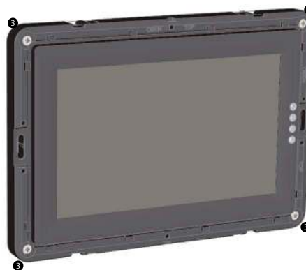
BT 800: Abnehmen des Gehäuseoberteils
