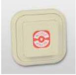
Überfallmelder zur manuellen Auslösung eines Überfallalarms in Einbruchmeldeanlagen. Die Drucktaste ist versenkt unter einer Papierplombe eingebaut. Beim Drücken der Taste wird die Papierplombe zerstört und somit eine eindeutige Identifizierung des ausgelösten Melders ermöglicht. Der Melder ist zur Auf- oder Unterputzmontage vorgesehen.
