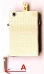
Der Schaltpunkt des RK-Lever in Bezug zum Schließblech lässt sich mit einer gut zugänglichen Schlitzschraube über handelsübliche Schraubendreher im Bereich 8 ... 20 mm einstellen, gemessen an Punkt „A“ (Ende Schalthebel).
