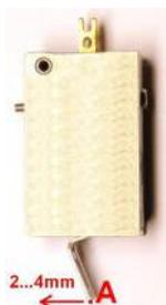
Die Schaltpunkt liegt bei einem Betätigungsweg von ca. 2...4 mm aus der Ruhestellung heraus, bezogen auf Punkt „A“ (Ende Schalthebel), unabhängig von der eingestellten Lage des Schalthebels.
