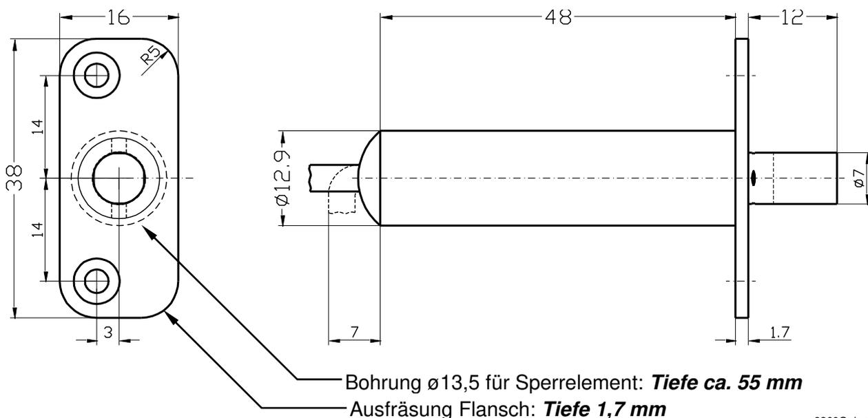
**Abbildung 2.1** - Montage Sperrelement
