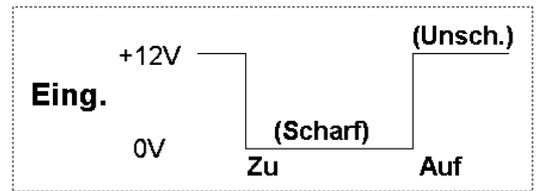
Abbildung 3.3 - Eingangsspannungsverlauf
